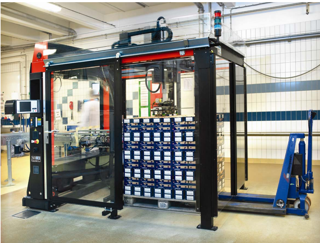
(SOCO_System_Arla_Foods_20.jpg): Robot-In-A-Box - en plug & play løsning: "Pak ud - tilslut - kør", og fylder kun lidt over en palle.
