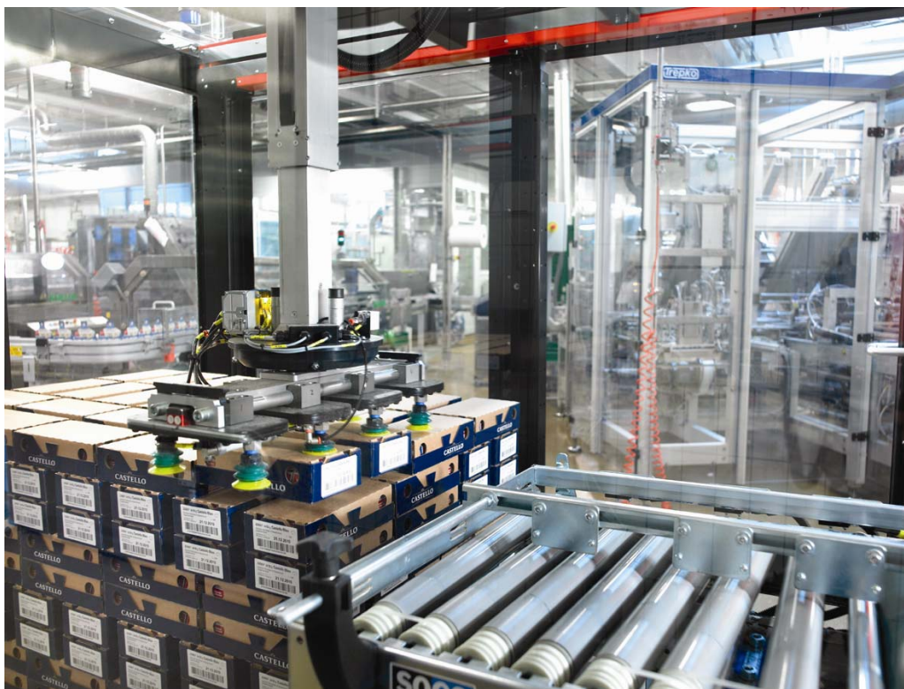
(SOCO_System_Arla_Foods_40.jpg): Det særlige multifunktionsgribehed henter op til 4 kartoner ad gangen og placerer dem på pallen med mellemrum, der sikrer den korrekte køling under opbevaring.
